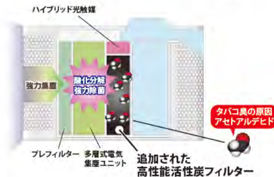
空気接触と光照射を効率化した形状のハイブリッド光触媒フィルターを搭載
